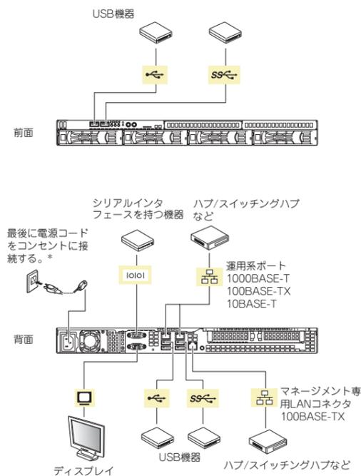
\* 電源コードは、15A以下のサーキットブレーカに接続すること。電源コードの脱落を防止するため添付のケーブルタイで電源コードを固定してください。
