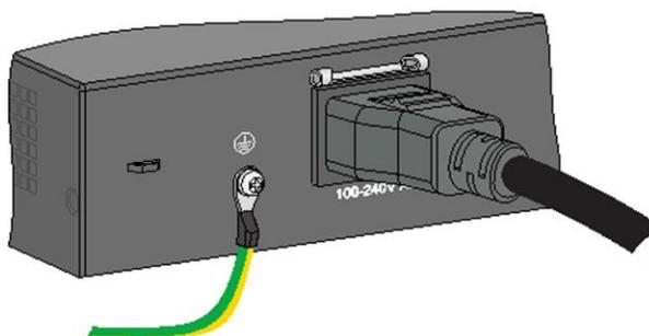
図 3-9 装置への電源ケーブルの接続 2
