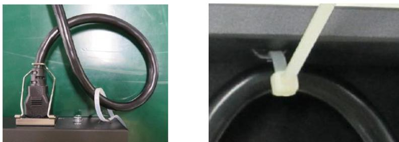
図 3-12 装置への電源ケーブルの接続 4
