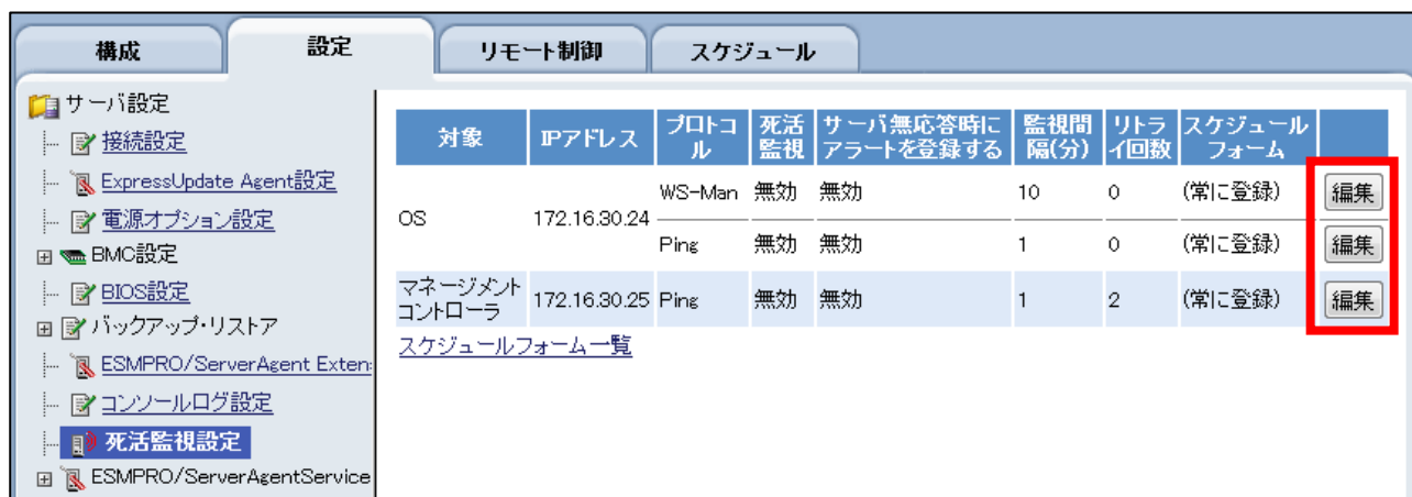
Figure 3 死活監視設定(OS(WS-Man/Ping)、マネージメントコントローラ)
