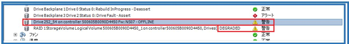
故障した物理デバイス(Drive 252\_54)のラベルに[OFFLINE]と表示され、右端のステータス欄が[警告]となります。また、論理ドライブ(Drive 252\_54を含むLogical Volume)のステータスが[警告]となります。
