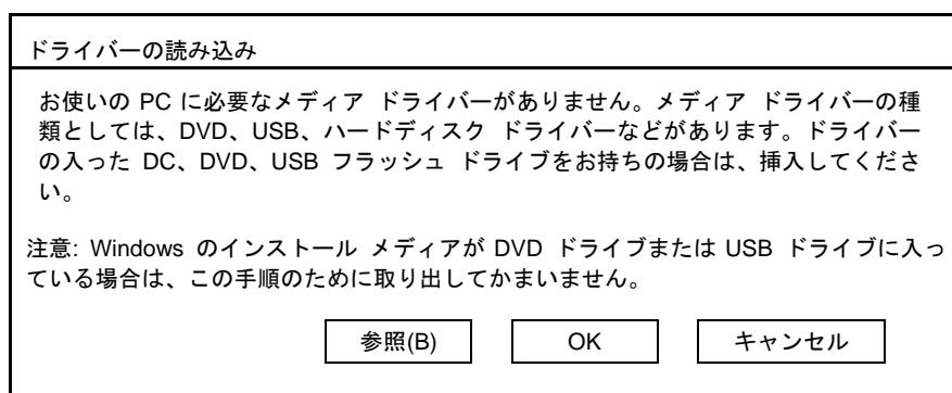
5. ドライバインストール用メディアをセットした後、参照先を指定して[OK]をクリックします。
