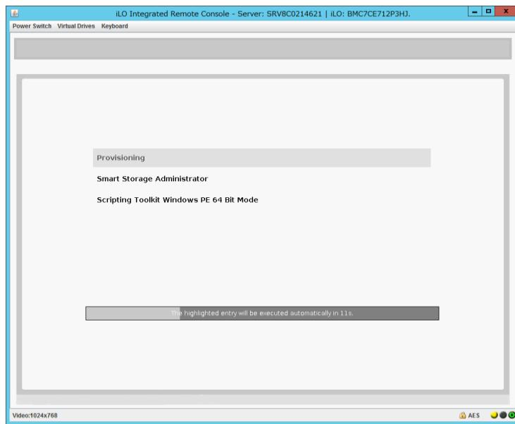
(3) メニューの「Provisioning」を選択します。何もキーを押さない場合、自動的に「Provisioning」が選択されます。
