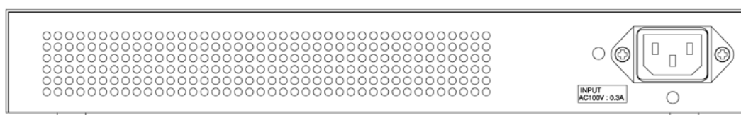
図 1-3 QX-S2110P-I Ethernet スイッチのリアパネル
