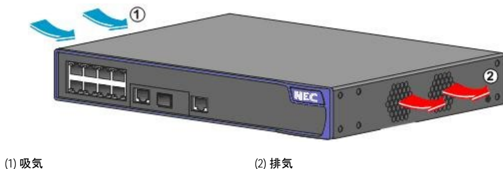
図 2-2 QX-S3300TP シリーズ(PoE モデル)の空気の流れ
