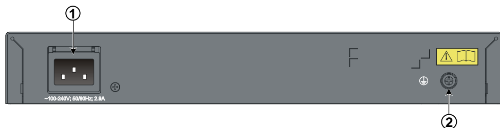
図 1-14 QX-S3318TP-PW Ethernet スイッチのリアパネル
