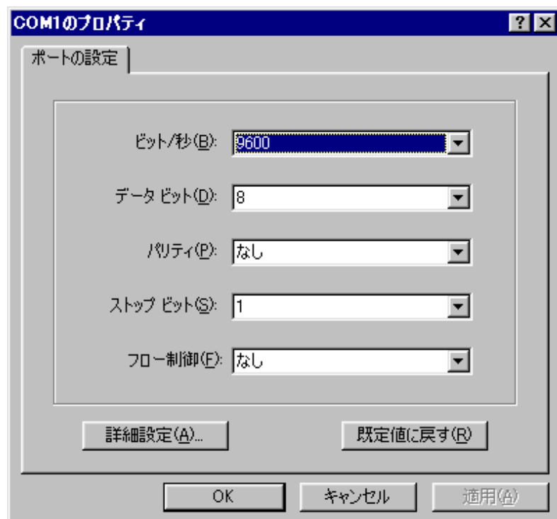
図4-4 シリアルインタフェースのパラメータ設定
