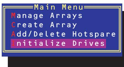
4. カーソルキーを使ってリストからイニシャライズをするハードディスクドライブを選び、<Insert>キーを押す。
