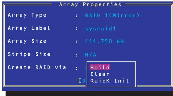
「Create RAID via」では、RAIDレベル(Array Type)との組み合わせでさまざまなRAIDドライブの作成方法を指定することができます。詳細を下表に示します。
