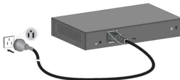
図 2-4 : 電源コンセントへの接続
