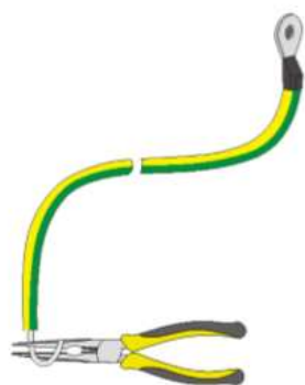
図 1-2 : アースケーブルの処理
