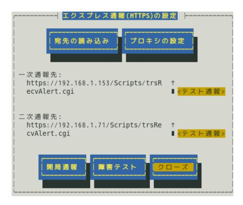
14) [エクスプレス通報サービスの基本設定]画面に戻ります。 通報の抑制の既定値は、抑制時間による抑制は有効で、抑制時間は 60 分です。 設定変更が可能ですが、保守サービス会社からの指示がある場合を除いて、既定値は変 更しないでください。
