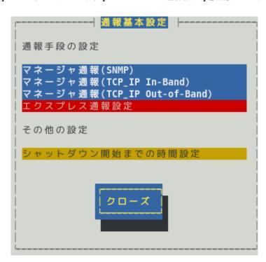
4) [エクスプレス通報サービスの基本設定]画面が表示されます。 [ダイヤルアップ経由]を選択して、エクスプレス通報有効にチェックを入れ、[設定…]ボタンを押します。
