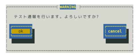
12) [開局通報]ボタンを押し、開局通報を確認します。 [開局通報]ボタンは、テスト通報完了後に押せるようになります。 開局通報が完了した時点でエクスプレス通報サービスが開始されます。
