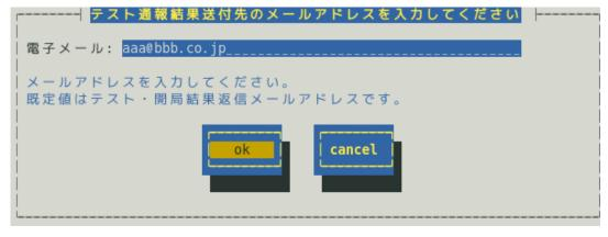
16) 確認メッセージが表示されますので、[ok]ボタンを押すとテスト通報します。 テスト通報完了後は、指定した結果送付先へのメールの到着をお待ちください。 テスト通報結果を確認した後で、開局通報してください。
