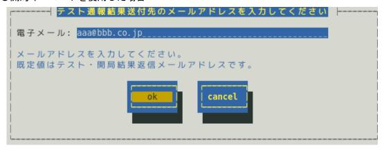
8) 確認メッセージが表示されますので、[ok]ボタンを押すとテスト通報します。 テスト通報完了後は、指定した結果送付先へのメールの到着をお待ちください。 テスト通報結果を確認した後で、開局通報してください。
