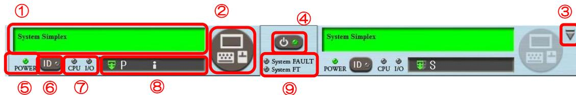
左側に CPU/I/O モジュール 0 のサーバパネルを表示し、右側に CPU/I/O モジュール 1 のサーバパネルを表示します。
