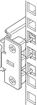
上図は右側(前面)を示していますが、右側(背面)、左側(前面/背面)も同様に取り付けてください。もう一方のレールを取り付ける時、すでに取り付いているレールアセンブリと同じ高さに取り付けることを確認してください。
