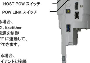
POW LINK スイッチを ON に設定して使用する場合、ExpEther クライアントの電源スイッチの操作で、ExpEther クライアントと接続したワークステーションの電源を制御したり、接続したワークステーションの ON/OFF に連動して、ExpEther クライアントを ON/OFF させることができます。
