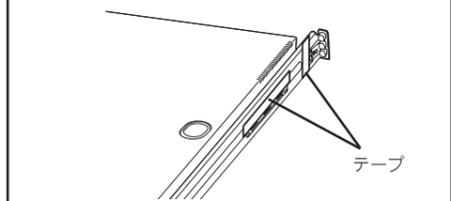
2 本体前面にあるロック解除ボタンを押しながら、レールを持ってゆっくりと装置後方へスライドさせる。
