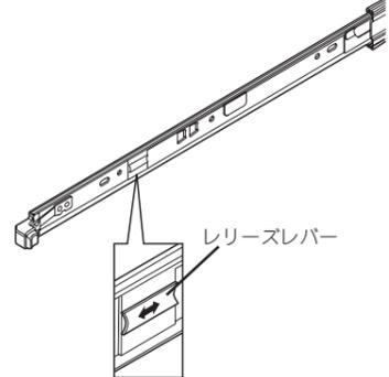
完全に装置を押し込むと装置前面のロックがかかり装置を固定できます。
