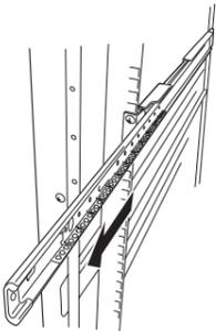
ロック機構が確実にロックしている事を確認してください。
