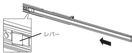
レールアセンブリは、取り外したインナーレールに再度取り付けます。どちら側のインナーレールから取り外したものがわかるように印を付けるなどして区別してください。複数の本装置を設置する際もどの装置のどちら側のインナーレールから取り外したものがわかるように区別してください。
