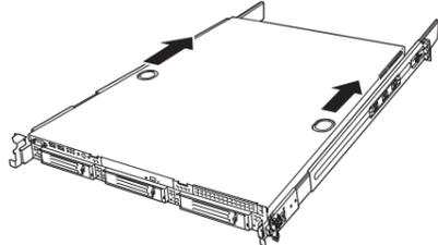
装置運搬時の脱落防止のために、工場出荷時にスライドレールは左右ともに背面側と側面がテープで固定されています。ラックへ取り付ける前に、テープをはがしてください。
