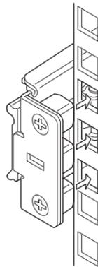
上図は右側(前面)を示していますが、右側(背面)、左側(前面/背面)も同様に取り付けてください。もう一方のレールを取り付ける時、すでに取り付けられているレールアセンブリと同じ高さに取り付けることを確認してください。
