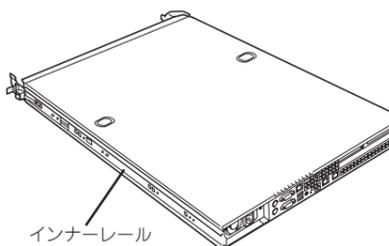
取り外したレールアセンブリは、レバーを押しながら矢印方向へ動かし、もとに戻してください。
