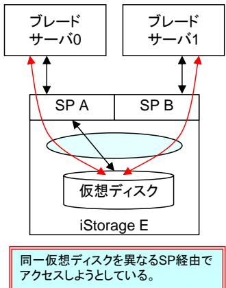
このような、Active-Standby の特性のため、単一経路故障による仮想ディスクへのアクセス障害が発生します。OS 起動後であれば、経路故障が発生しても、冗長パスソフトウェア(SPS や VMware ESX の Native パス切り替え機能)により、Standby パスへのオーナ権の切り替えが行われるため、業務 IO を継続することができます。
