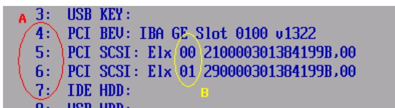
図内の A の数字がブートの優先順位になります。この部分に Fibre Channel コントローラのポートが設定されていない場合は、ブートできません。
