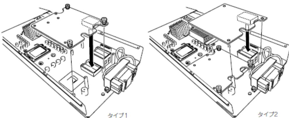
120Bb シリーズ、B120 シリーズの場合、FC コントローラを下段に取り付けた場合(左図)は「メザニンスロット 1」への装着となります。上段に取り付けた場合(右図)の場合は「メザニンスロット 2」への装着となります。
