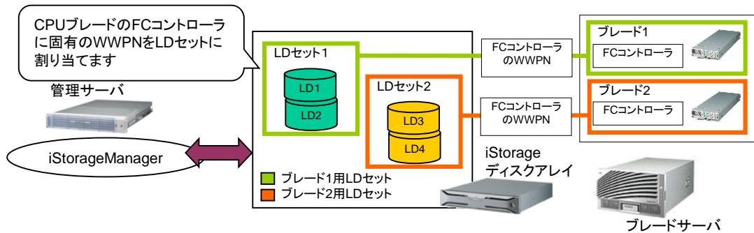
iStorageManager を用いて「3.1.2 LD セットの構築」で作成した LD セットに、SAN ブートを行うサーバに実装された FibreChannel コントローラの WWN(WWPN)を関連付けます。
