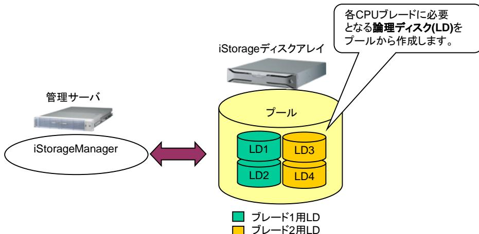
iStorageManager を用いてプールと論理ディスク(以下 LD と略します)の構築を行います。iStorage-D シリーズの場合、「iStorage シリーズ構成設定の手引(GUI 編)」の「4.1.3 プールまたは RANK の構築」および「4.1.4 論理ディスクの構築」を参照してください。
