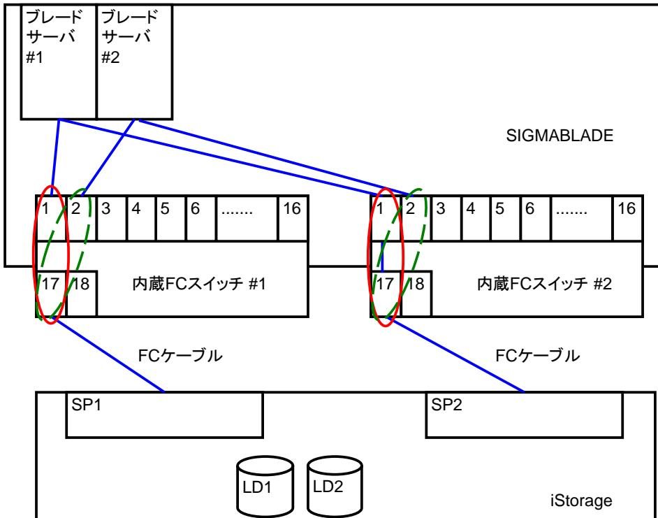
ブレードサーバ#1 および#2 と内蔵 FC スイッチ間は筐体内のミッドプレーンにより、ブレードサーバ# 1 は FC スイッチの Port# 1 へ、Blade#2 は Port# 2 に固定的に接続されます。
