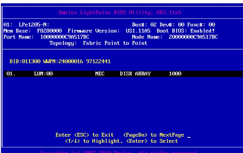
10 以下の画面が表示されたら、[Boot this device via WWPN]を選択し、Enterキーを押す。
