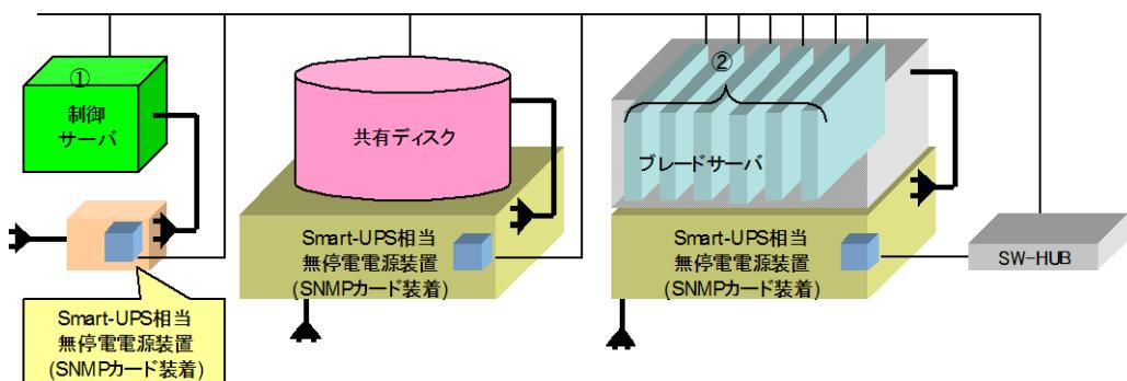
本構成の場合、シャットダウン時の共有ディスクへのディスクフラッシュ処理要求および、起動時の無停電電源装置の起動順序制御を、制御端末(制御サーバ)が実施します。ただし本構成の場合、共有ディスクの起動処理中にブレードサーバが起動すると、ブレードサーバから共有ディスクへのアクセスが失敗し、その結果としてブレードサーバのOS起動に失敗する現象が発生する場合があります。そこで本構成ではブレードサーバの起動開始を遅らせる設定を AMC から行ないます。
