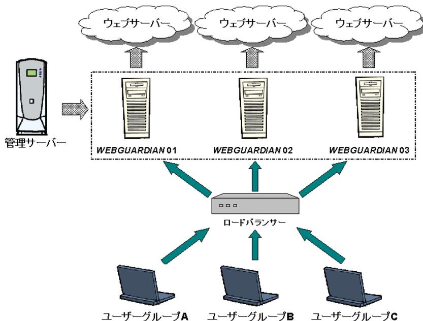
また、上図のようにロードバランサー（負荷分散装置）を設置することで利用者のユーザー端末に対して透過的に **WEBGUARDIAN** を複数台構成にすることができ、全体のスループットを向上させることが可能です。
