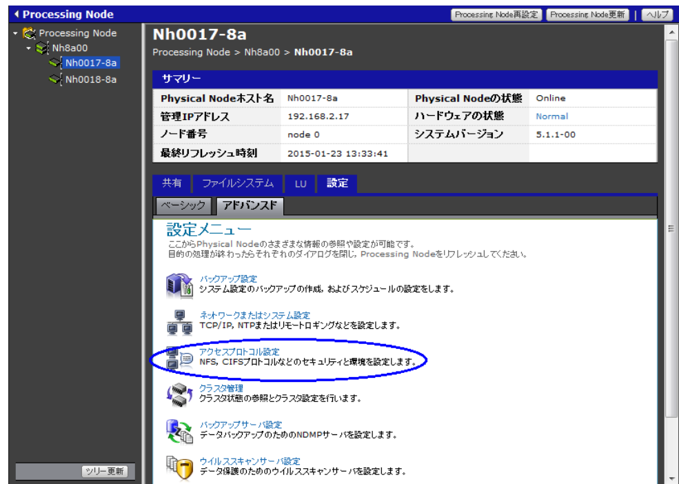
図 9-2 : [Access Protocol Configuration] ダイアログの表示
