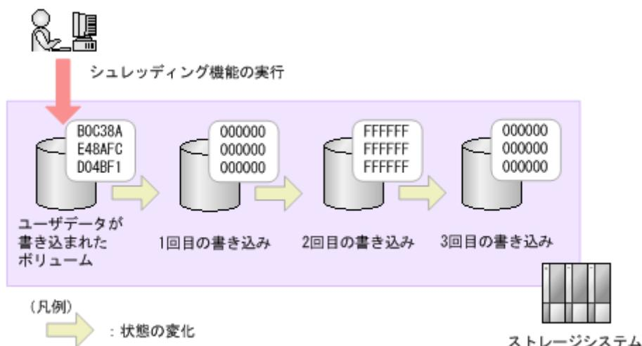
シュレッディング機能を実行すると、ユーザデータが書き込まれたボリューム全体にダミーデータが書き込まれ、ユーザデータは消去されます。ただし、ドライブ（以降、ハードディスクドライブ、SSD を指します）の特性上、1回の上書きだけでは、ユーザデータの消去が不完全になり、消去したはずのユーザデータを復元できてしまうおそれがあります。
