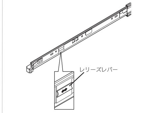
完全に装置を押し込むと装置前面のロックがかかり装置を固定できます。
