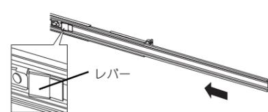
レールアセンブリは、取り外したインナーレールに再度取り付けます。どちら側のインナーレールから取り外したものがわかるように印を付けるなどして区別してください。複数の本装置を設置する際もどの装置のどちら側のインナーレールから取り外したものがわかるように区別してください。
