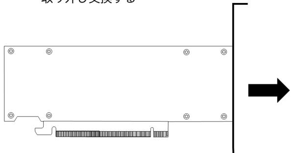
3. ロープロファイルブラケットを矢印方向に取り付ける
