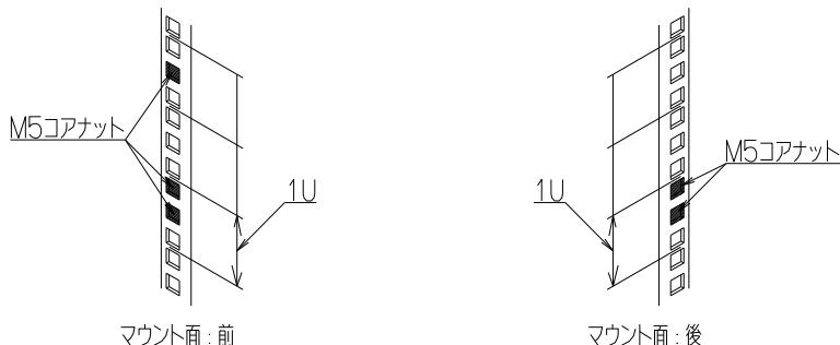
4. アウターレールの前後を添付のM5ネジ8本を使い、軽くねじ止めして下さい。
