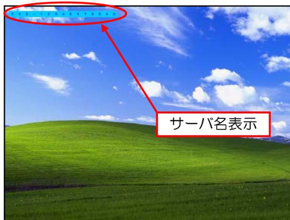
本製品はサーバの通常運用時（ホットキーモードや Auto Scan モード以外）に<Shift>キーと<Fn>キーを押しながらか<Scroll Lock>キーを 2 回連続で押すことにより、選択中のポートのサーバ名をコンソール画面左上に表示し続けることができます。
