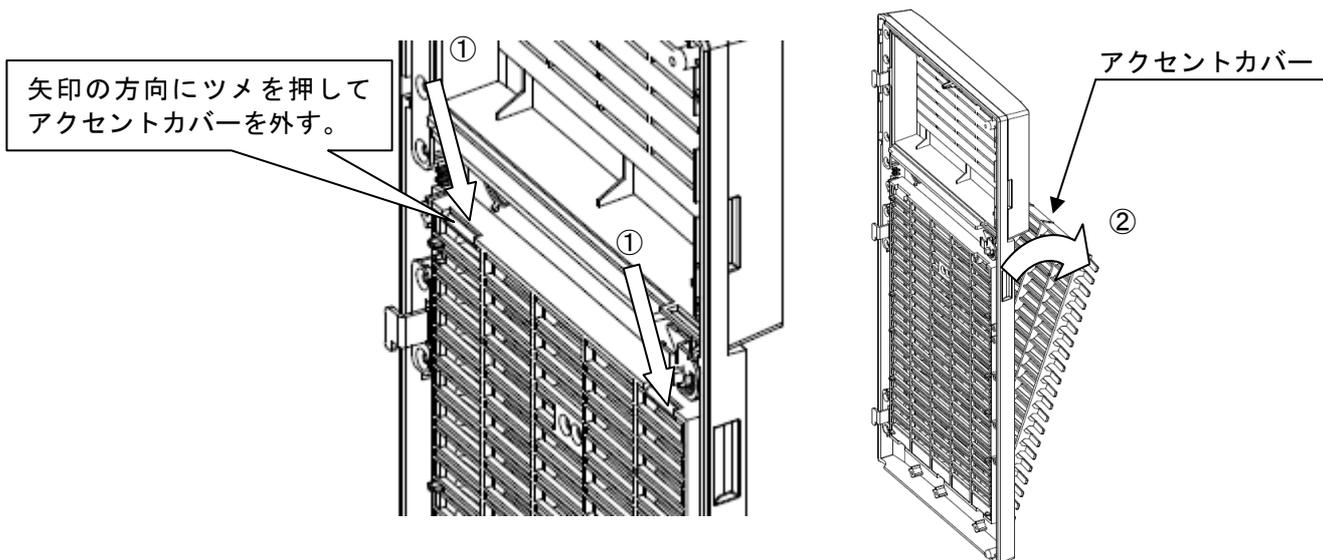
5. 前項のアクセントカバーの取り外しと逆の手順で防塵カバーをフロントベゼルに取り付けます。
