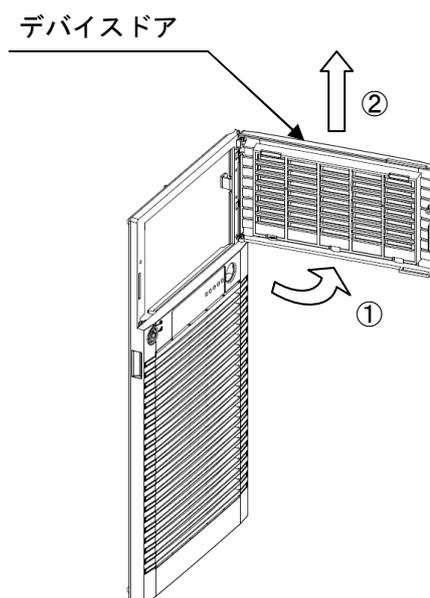
3. 前項のデバイスドアの取り外しと逆の手順で防塵ドアを取り付けます。
