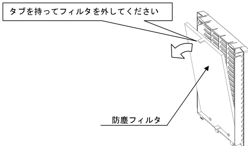
2.2 取り外しと逆の手順で防塵フィルタのタブが手前側になるように防塵カバーにセットしてください。
