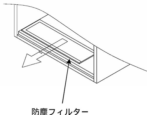
3. 防塵フィルターを交換後、逆の手順で前トリムを取り付けます。
