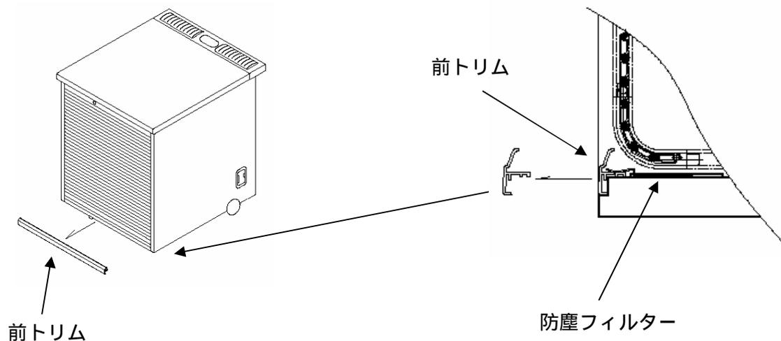
2. 防塵フィルターを取り外し、新品（1枚）と交換します。
