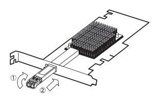
**6**. SFP+モジュールと干渉しないことを確認しながら、2. で取り外した本体装置のカバーや部品を取り付けます。
