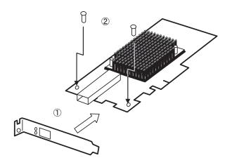
4. 1. で取り外した SFP+モジュールを取り付けます。
