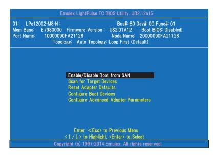
5〉 "Reset Adapter Defaults"を選択しくEnter>を押します。下記の確認メッセージが表示されますのでくY>を押してポートの設定を初期状態に戻します。
