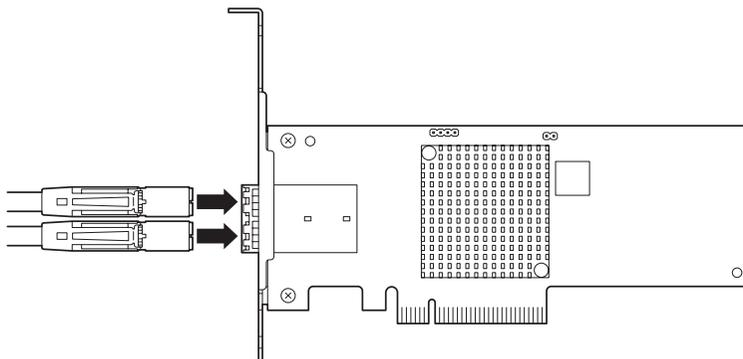
3. SAS ケーブルの他方のコネクタの向きを、SAS 機器のコネクタの向きに合わせて接続します。
