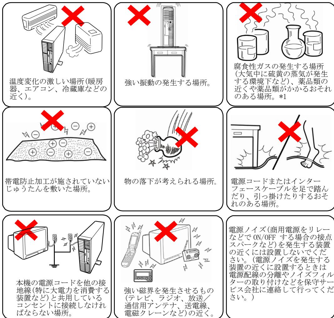
\*1：腐食性ガス(二酸化硫黄、硫化水素、一酸化窒素、二酸化窒素、塩素、アンモニア、オゾンなど)の存在する場所(※)。また、ほこりや空気中に腐食を促進する成分(塩化ナトリウムや硫黄など)や導電性の金属などがふくまれている場所。
