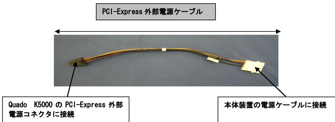
また、本体装置の電源ケーブルが不足する場合には別途添付してあります電源分岐ケーブルを使用して電源コネクタの口を増設してご使用してください。
