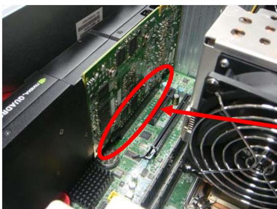
PCI-Express カードエッジコネクタを本体装置の PCI-Express x16 スロットにカードが奥まで確実にセットされるように、しっかりと挿し込む。
