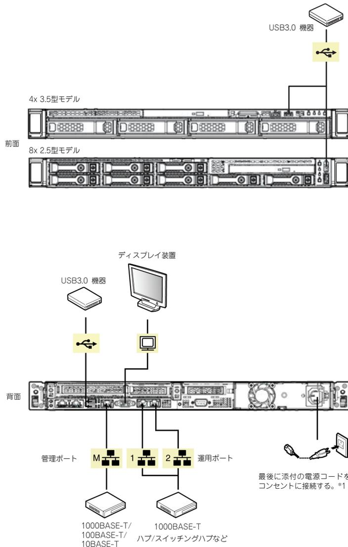
\*1 電源コードは、15A以下のサーキットブレーカーに接続してください。
