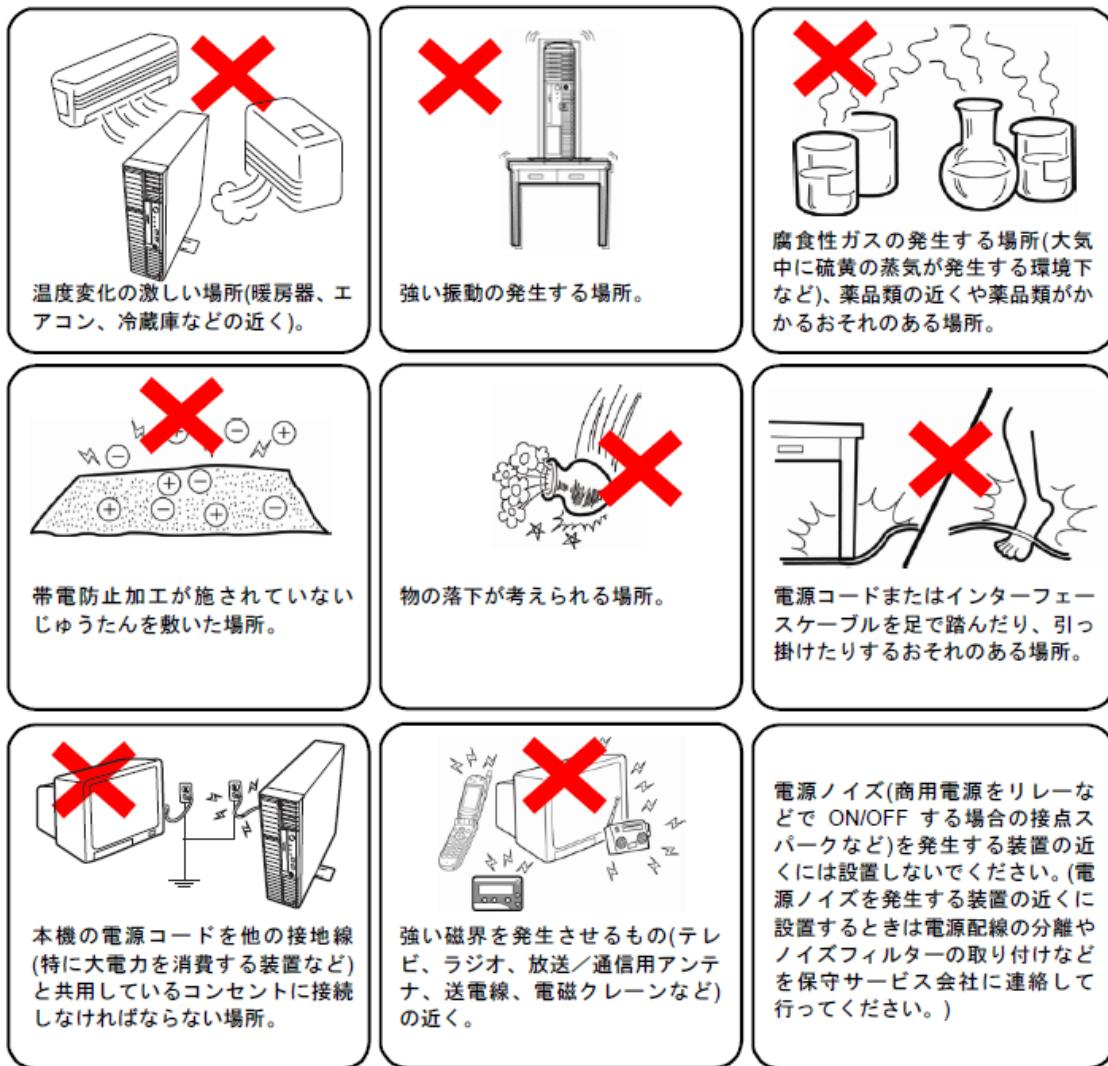
\*1 : 腐食性ガス(二酸化硫黄、硫化水素、一酸化窒素、二酸化窒素、塩素、アンモニア、オゾンなど)の存在する場所。 (※)
