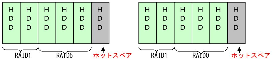
③大規模システム例（物理デバイス6台・内部ケージ物理デバイス 14 台・外部 DISK 増設筐体）
