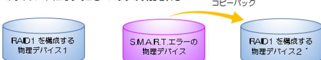
(3) コピー/バック完了後、S.M.A.R.T.エラーが発生したディスクは故障となる
