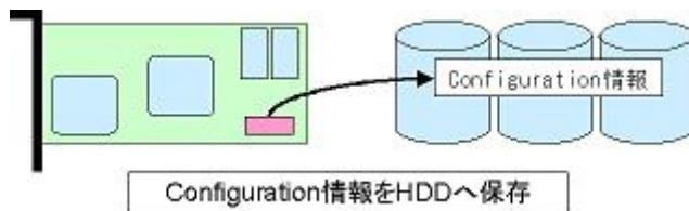
注意： 故障や保守交換時など、交換した RAID コントローラにコンフィグレーション情報がすでに存在している場合、RAID コントローラ内のコンフィグレーション情報をクリアしてから物理デバイスを接続してください。
