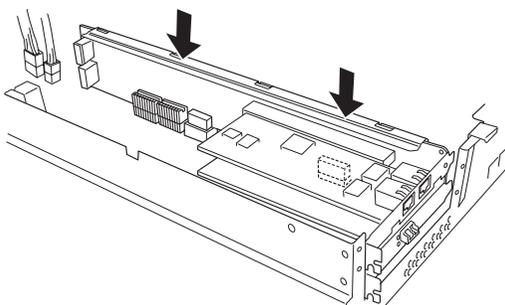
8. PCIブラケットを固定ネジ(3本)で固定する。
