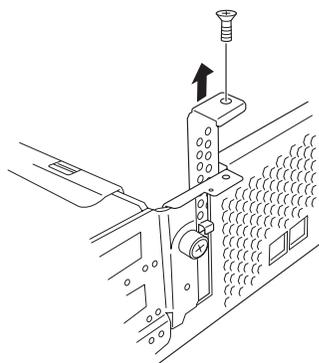
11. ライザーカードに隠れているもうひとつのPCIスロットにオプションのPCIボードを装着する。
