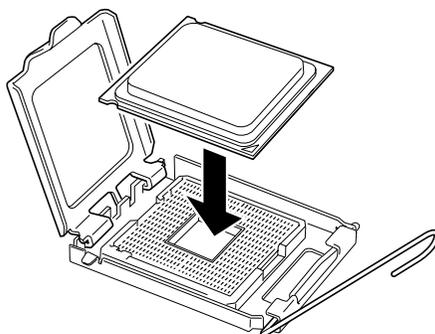
11. CPUを軽くソケットに押しつけてからCPUソケットホルダを元に戻す。
