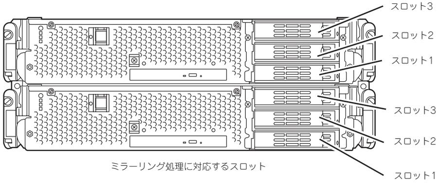
3.5インチハードディスクドライブベイの空きスロットにはダミートレーが入っています。ダミートレーは装置内部の冷却効果を高めるためのものです。ハードディスクドライブを搭載していないスロットにはダミートレーを取り付けてください。
