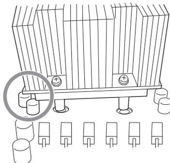
14. ヒートシンクがマザーボードと水平に取り付けられていることを確認する。
