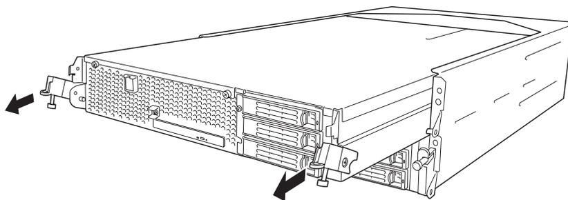
6. 途中でロックがかかり、引き出せない状態になっているので、CPU/IOモジュール側面にあるロックを下げてロックを外し、そのまま引き出す。
