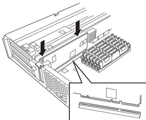
12. PCIボードを固定ネジ(1本)で固定する。
