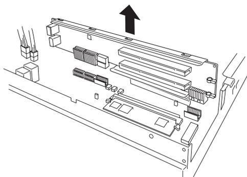
5. ライザーカードの2つのPCIスロットにオプションのPCIボードを取り付ける。
