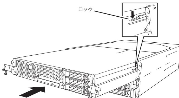
2. CPU/IOモジュール前面の両端にある黒いレバーを上げ、ネジで固定する。
