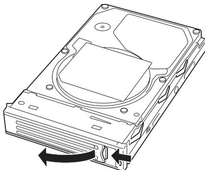
7. 増設するハードディスクドライブ(トレー付き)のハンドルをしっかりと持ってスロットへ挿入する。
