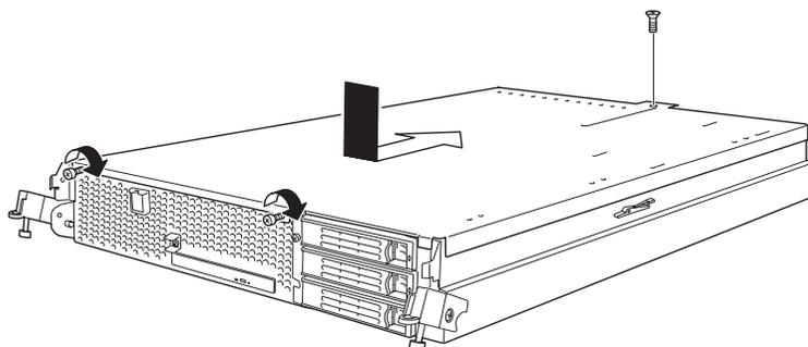
9. 8-15ページを参照してCPU/IOモジュールを取り付ける。
