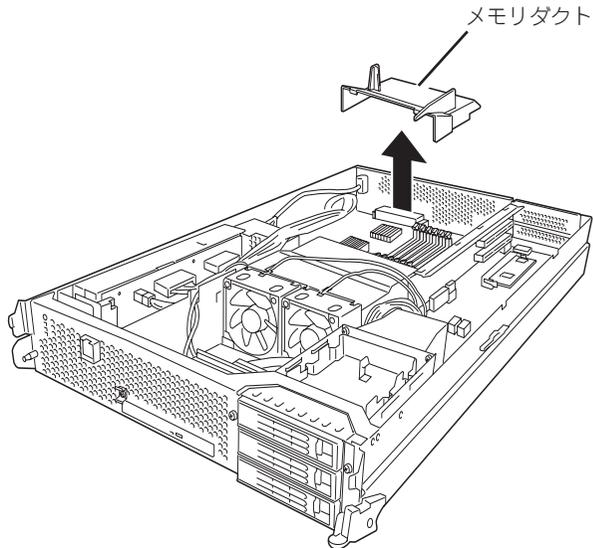
6. DIMMを取り付けるソケットを確認する。
