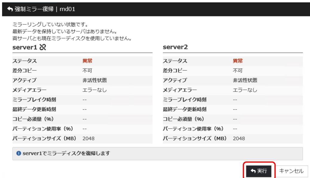
7. 強制ミラー復帰したサーバのステータスが「正常」になっていることを確認します。
