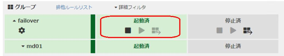
3. [ミラーディスク] タブを選択して「ミラーディスクリスト」を表示し、ミラーディスクリソースが起動していることを確認します。
