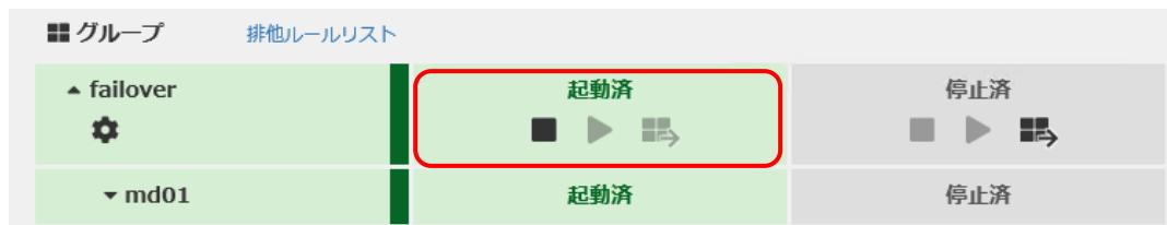
9. [ミラーディスク] タブを選択して「ミラーディスクリスト」を表示し、ミラーディスクリソースが起動していることを確認します。
