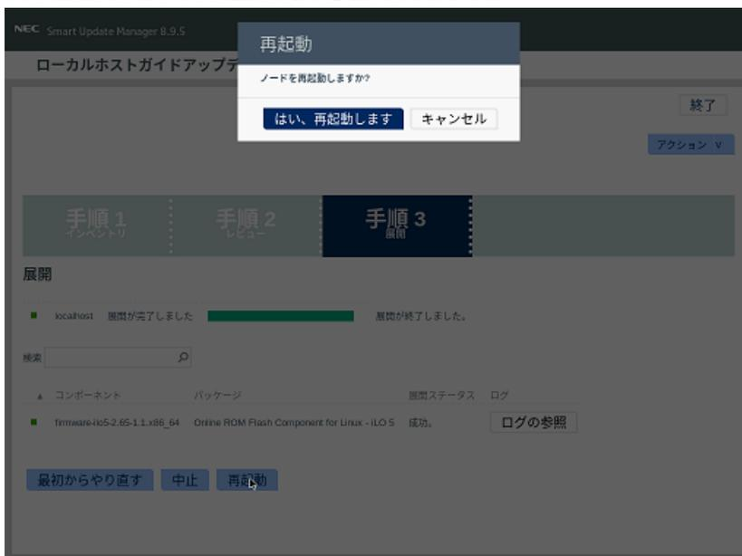
※[はい、再起動します]を、クリックしても再起動しない場合は、右上の[終了]をクリックし、さらに右上の電源アイコンをクリックして再起動を選択してください。
