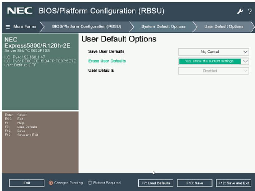
変更後、<F12> キーを押してシステムユーティリティを終了し、サーバーを再起動します。
