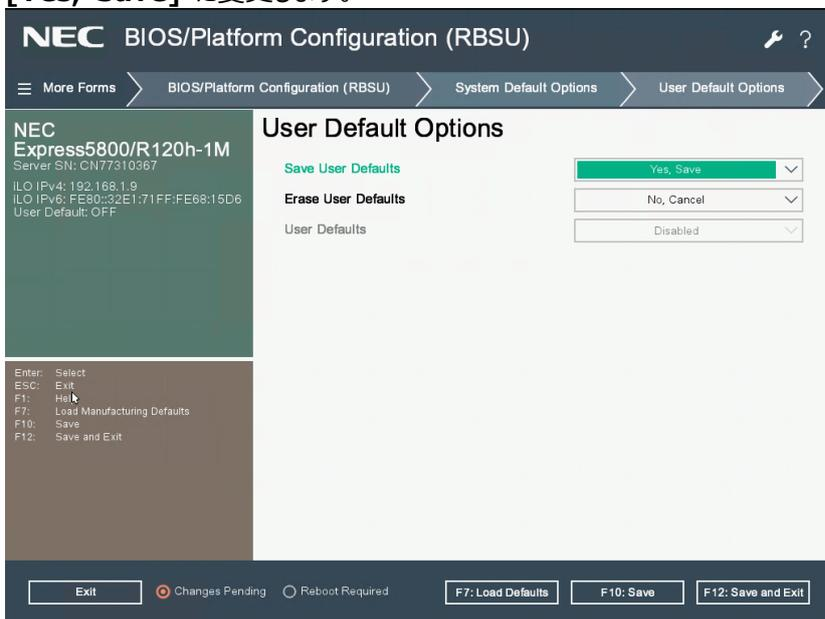
変更後 <F12> キーを押し、システムユーティリティを終了させ、サーバーを再起動します。
