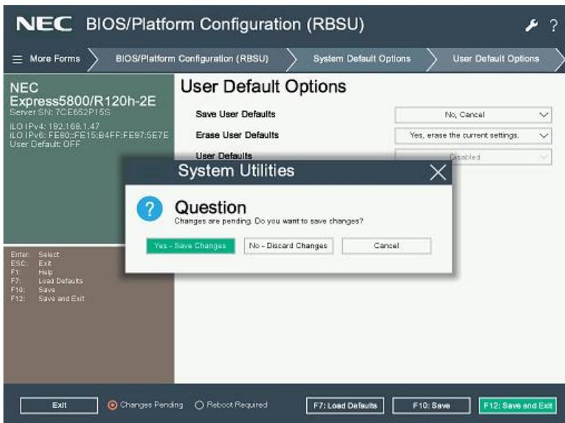
(2) 「BIOS/Platform Configuration (RBSU)」の設定のうち、デフォルトから変更した項目を記録します。設定をデフォルトに戻した後、各種ファームウェアのダウングレードを実施します。
