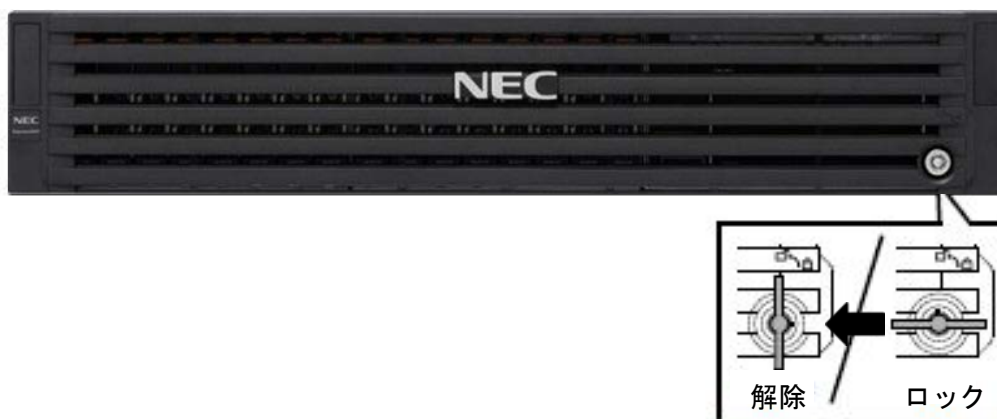
図 3-4 フロントベゼルの取り外し(1)
