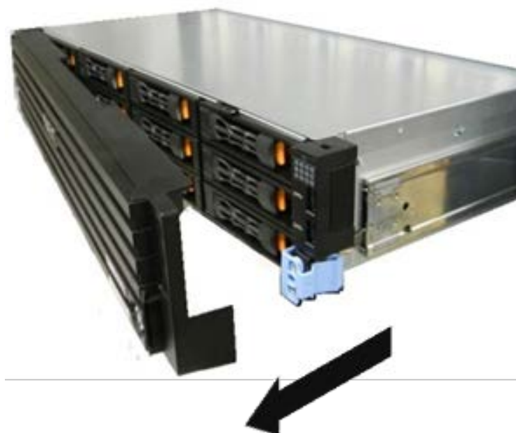
図 3-5 フロントベゼルの取り外し(2)
