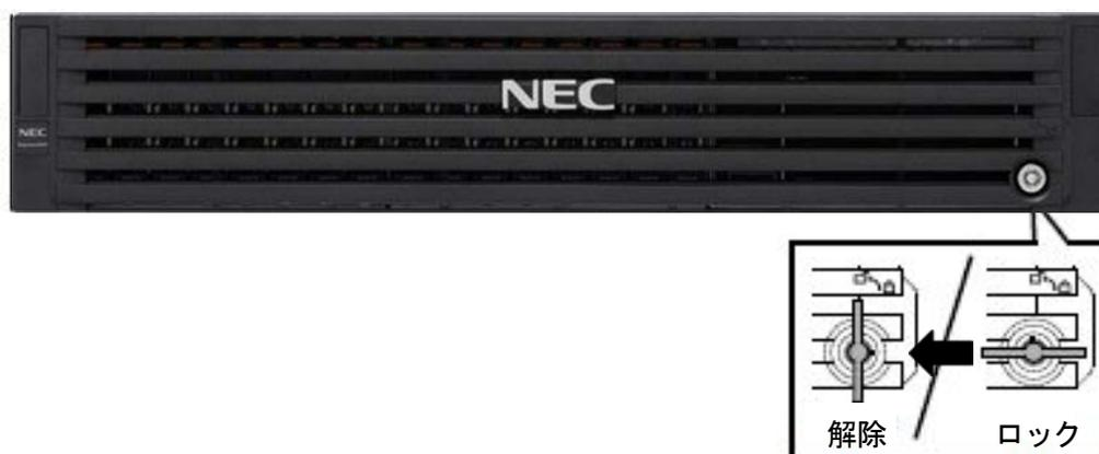
2. フロントベゼルを取り付けるときは、フロントベゼルのマウンティングイヤーにあるキャッチを合わせて、取り付けます。取り付け後はキーでロックしてください。
