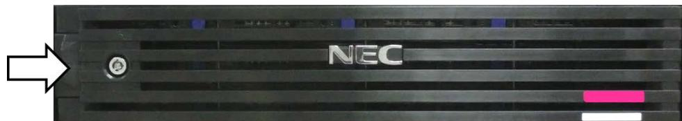
3. 次に、左側のロックが解除されたことを確認し、フロントベゼルの左端を持って手前に引いて、装置から取り外してください。
