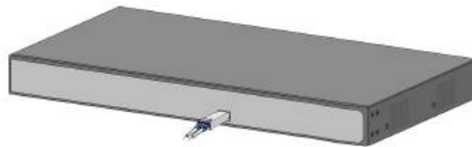
図 8-13 トランシーバモジュールの挿入
