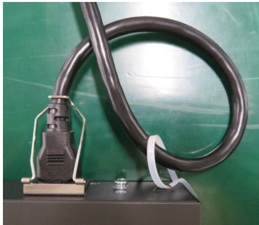
図 3-19 AC 電源ケーブルの固定
