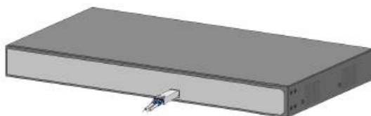
図 8-19 トランシーバモジュールの挿入
