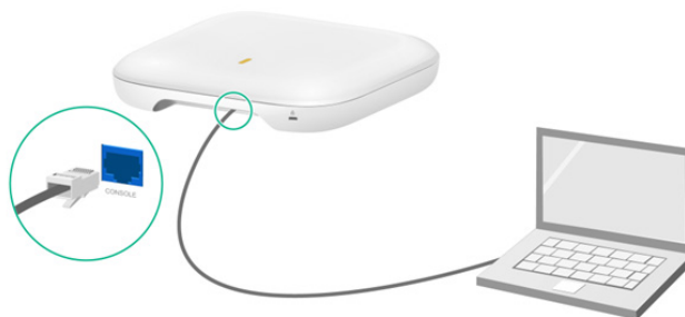
図 4-1 コンソールケーブルの接続
