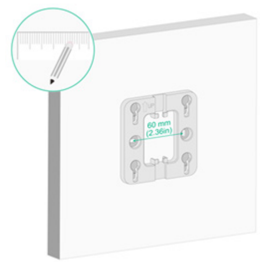
図 7-16 壁面の設置用の穴の位置のマーキング
