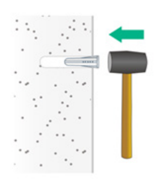
図 7-18 アンカー(壁用)の打ち込み
