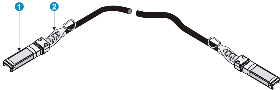
図 10-1 10G SFP+ 銅線ケーブル
