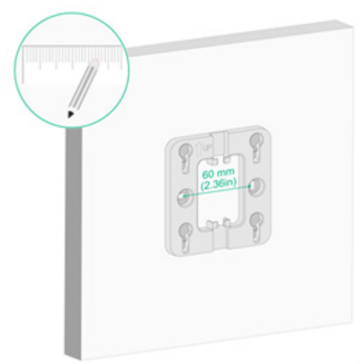
図 7-1 壁面の設置用の穴の位置のマーキング
