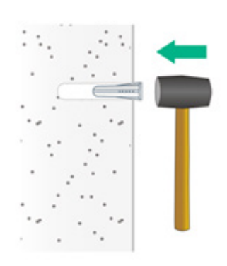
図 7-3 アンカー(壁用)の打ち込み
