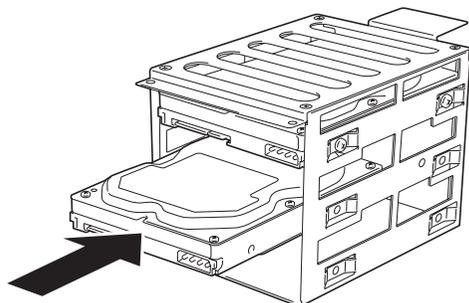
7. ハードディスクドライブに添付のネジ（4本）を使用して、ハードディスクドライブベイにハードディスクを固定する。
