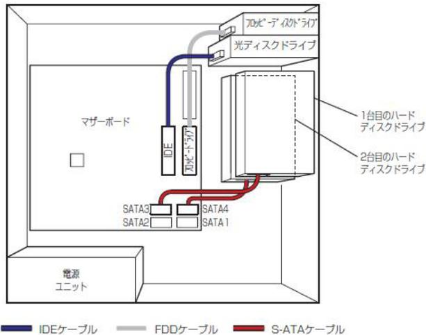
シリアルATAハードディスクドライブを2台接続している場合は、マザーボード上のコントローラを利用して2台のハードディスクドライブでディスクアレイを構築することができます。構築できるRAIDレベルや構築方法の詳細については、「RAIDコンフィグレーション」(159ページ)を参照してください。
