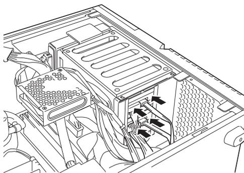
10. ハードディスクドライブに接続したSATAケーブルのもう一方のコネクタをマザーボードのSATAコネクタに接続する。
