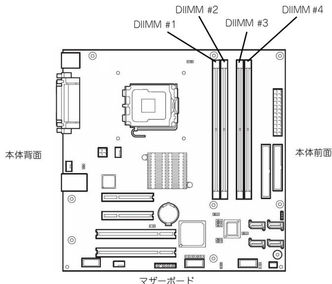
また、本装置ではメモリのDual Channelメモリモードをサポートしています。Dual Channelメモリモードで動作させるとメモリのデータ転送速度が2倍となります。
