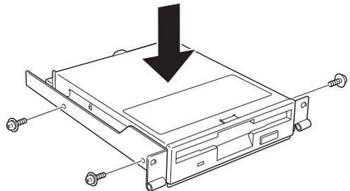
8. 3.5インチドライブトレイを元に戻し、固定ネジ（2本）で固定する。
