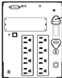
ご使用時にバッテリー接続コネクタを接続してください。移設等で移動する際は外してください。
