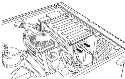
5. ハードディスクドライブベイのネジ（4本）を外し、ハードディスクドライブベイを取り外す。
