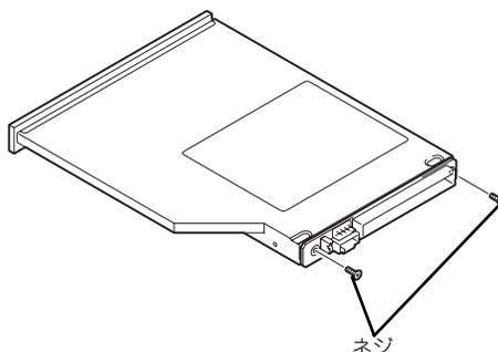
9. DVD-RAMドライブの背面に手順8.で取り外したアダプタと手順7.で取り外したODDベイを取り付ける。
