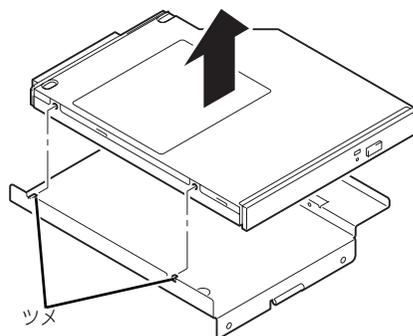
8. 光ディスクドライブの背面にあるアダプタの固定ネジ（2か所）を外し、アダプタを取り外す。
