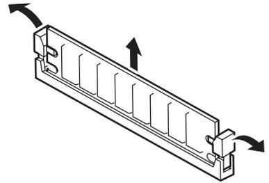
2. 取り外すDIMMのコネクタの両側にあるレバーを左右にひろげる。
