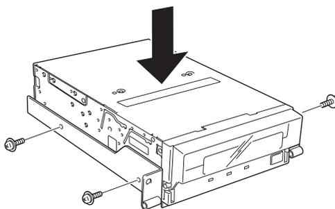
8. 3.5インチドライブトレイを元に戻し、固定ネジ（2本）で固定する。
