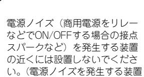
電源ノイズ（商用電源をリレーなどでON/OFFする場合の接点スパークなど）を発生する装置の近くには設置しないでください。（電源ノイズを発生する装置の近くに設置するときは電源配線の分離やノイズフィルタの取り付けなどを保守サービス会社に連絡して行ってください。）
