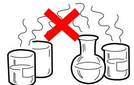
腐食性ガスの発生する場所（大気中に硫黄の蒸気が発生する環境下など）、薬品類の近くや薬品類がかかるおそれのある場所。
