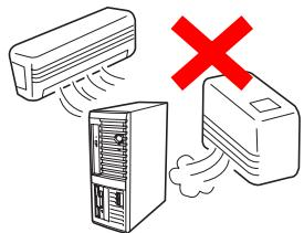
温度変化の激しい場所（暖房器、エアコン、冷蔵庫などの近く）。
