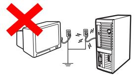
本装置の電源コードを他の接地線（特に大電力を消費する装置など）と共に用いているコンセントに接続しなければならない場所。
